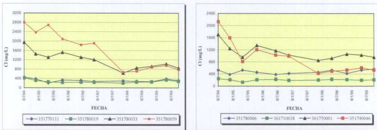
Figura 12: diagramas de evolución de cloruros para algunos puntos de la red de intrusión del IGME
